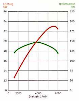
Leistungs-Drehmoment-Diagramm 1.6, 74 kW (100 PS)
